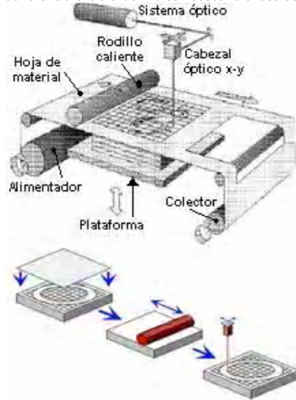
Figura 14. Esquemas proceso LOM
