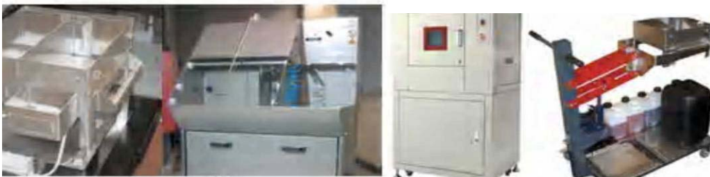
Figura 3. Equipos accesorios SL. a) Cuba de doble cámara, b) Lavadora, c) Horno UV para postcurado, d) Carro transportador que permite a una sola persona manipular fácilmente varias piezas.
