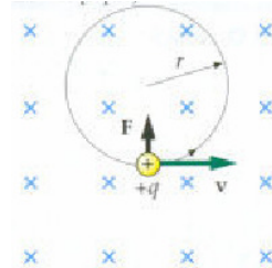
Figura 7. Portador de carga que se desplaza en un plano perpendicular a un campo magnético uniforme
