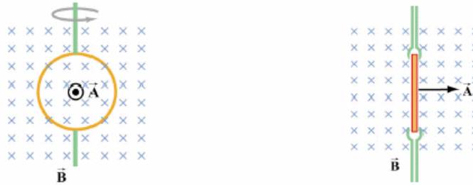
Figura 17. Se induce una fem como consecuencia de la variación del ángulo entre el campo magnético y el vector área.
