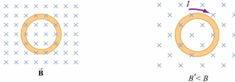
Figura 15. Se induce una fem variando el valor del campo magnético, es decir si el campo magnético va disminuyendo se induce una corriente que trata de compensar la disminución de flujo magnético.
