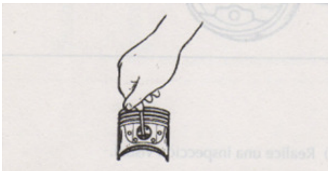
(Fig. 3.54).Medición del D. I.
