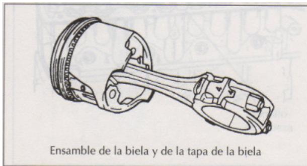
(Fig.3.142). Instalación de la tapa de la biela.
