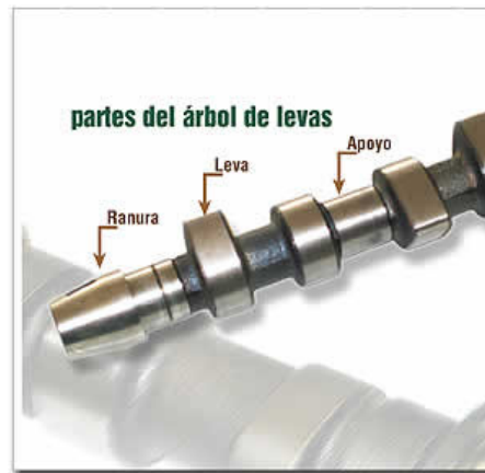
(Fig. 1.21). Partes de un árbol de levas.
