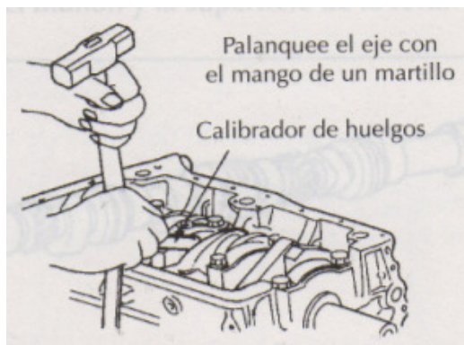
(Fig. 3.79).Acción de colocación para la medición.
