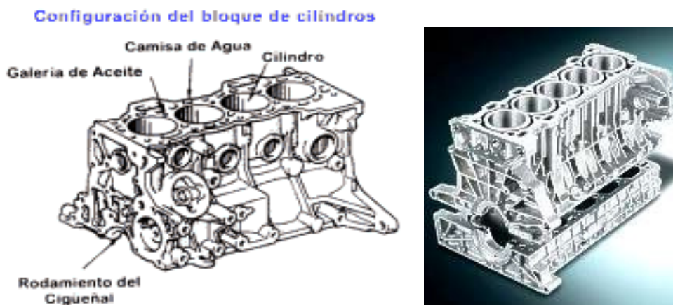
(Fig. 1.19). Partes principales y vista completa del bloque.
