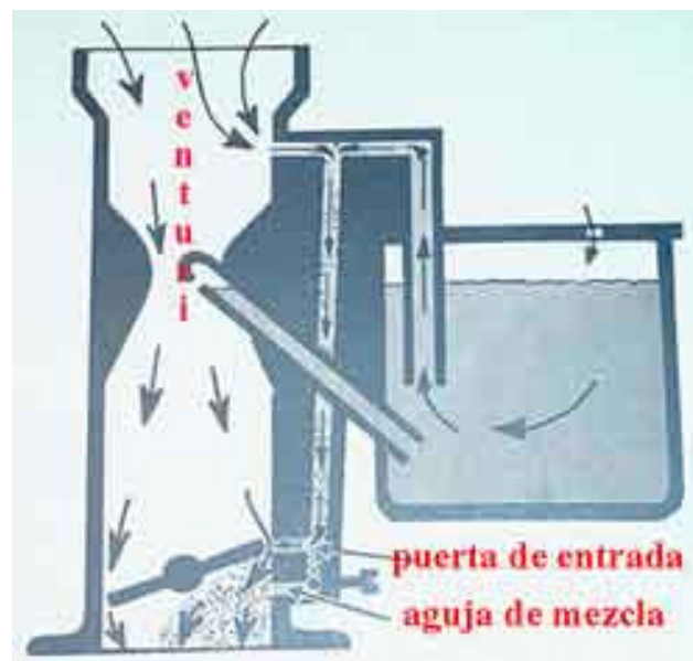
(Fig. 1.25) Esquema de las partes básicas de un carburador
