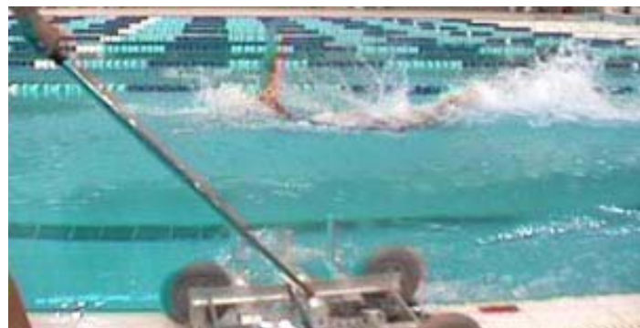
Foto 2 Sistema para portar la cámara en filmaciones subacuáticas
