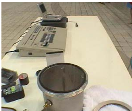
Foto 1 Mezclador de imagen y carcasa para filmar bajo el agua
