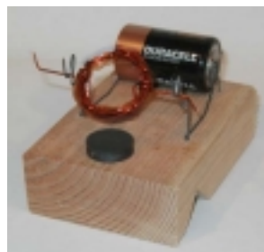
Fig. 9. Otros métodos para montar un motor eléctrico sencillo
