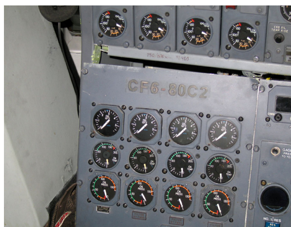
Figura 3. Panel del mecánico de a bordo
