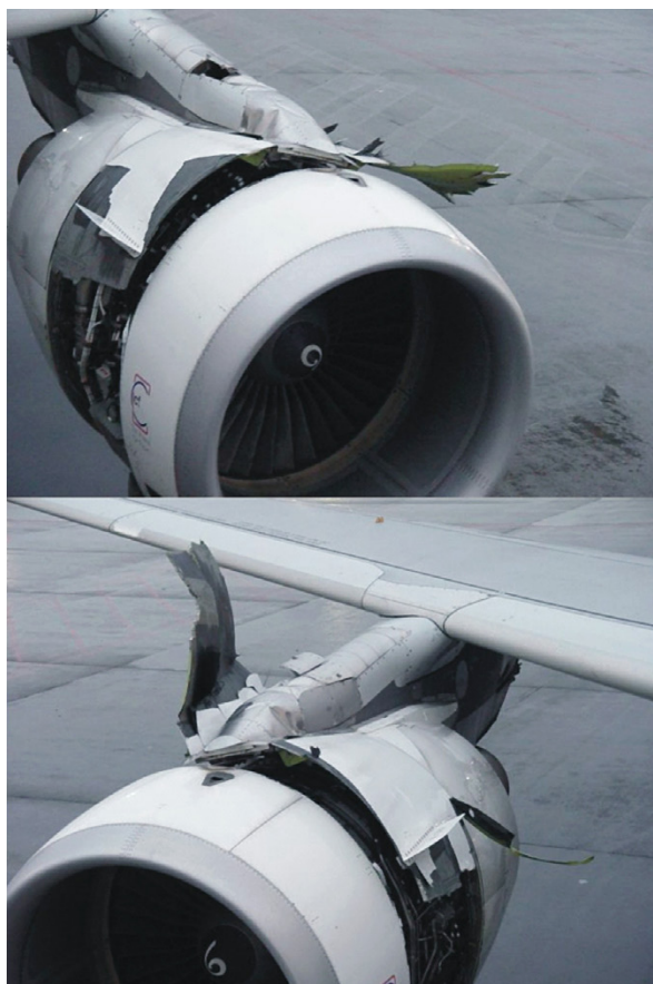
Figura 1. Daños en capós y carenado de los motores
