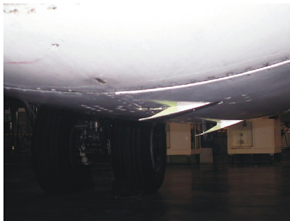
Figura 3. Capós cerrados y pestillos sin enganchar Figura 4. Pestillos enganchados y sin asegurar
