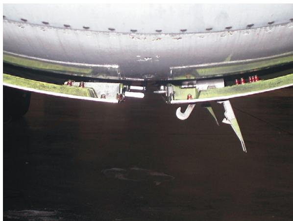
Figura 3. Capós cerrados y pestillos sin enganchar Figura 4. Pestillos enganchados y sin asegurar
