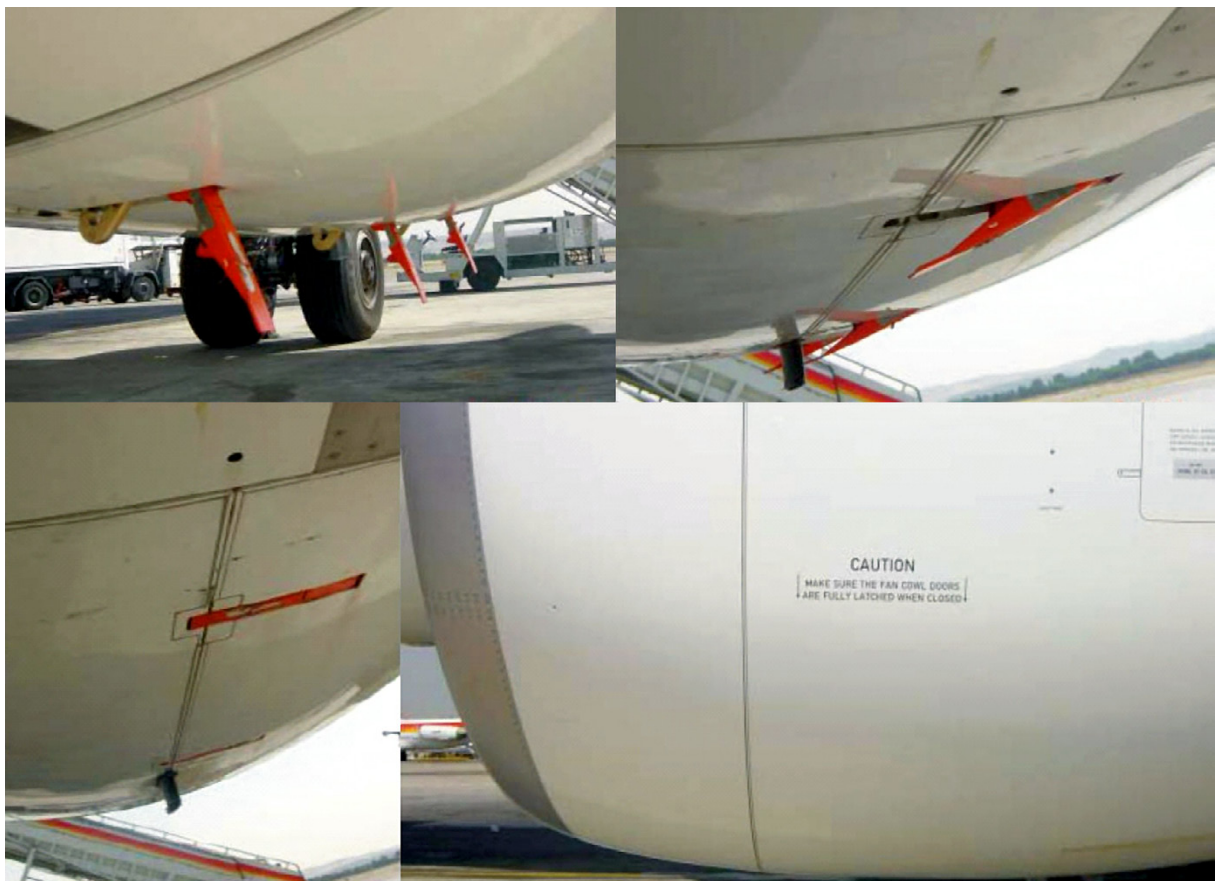
Figura 5. Pestillos pintados y marcas, de acuerdo con el SB RA32071-117, de Goodrich
