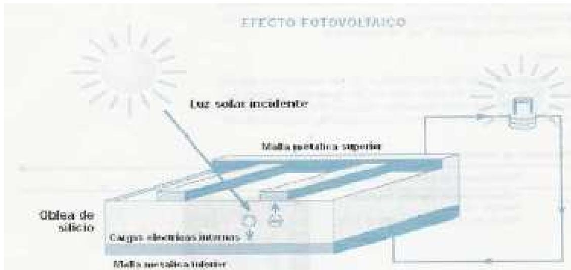
**Figura 5: Representación del efecto fotovoltaico**
