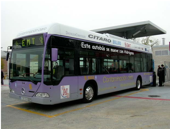
Figura 4. Ejemplos: Izquierda arriba: pila de metanol de UltraCell alimentando un ordenador portátil ; derecha arriba: monocelda plana SOFC lista para test en el laboratorio ; Izquierda abajo: autobús urbano del programa CUTE en Madrid movido por Pila de Combustible de 150 kW de Ballard ; derecha abajo: generador medio (1200 W) de Ballard .
