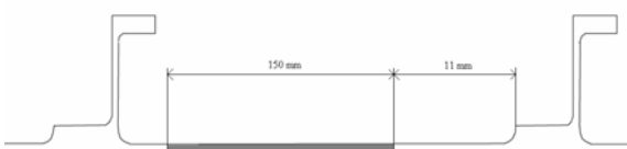
Figura 9: Detalle de las dimensiones y la posición de la grieta [7]
