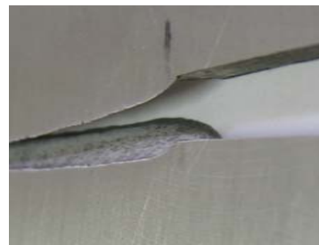
Figura 5: Detalle de la superficie de rotura de probeta C(T) ensayada por INTA/AES
