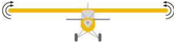
Figura 2.4 Flujo del aire en las puntas del ala
